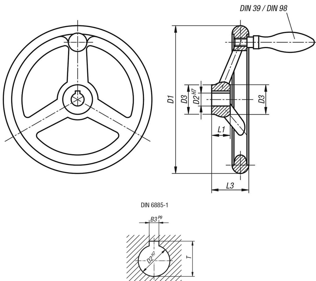
**Маховики из серого чугуна, DIN 950, с жестко установленной фасонной ручкой**
