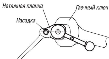
При монтаже насадки на зажимную консоль следует блокировать консоль от прокручивания с помощью гаечного ключа.
