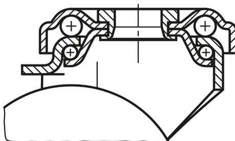
**Направляющие ролики для аппаратуры, с функцией stop fix, с цельнолитыми резиновыми шинами, стандартное исполнение****Обзор изделий**
