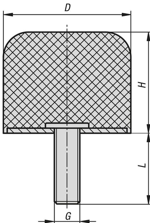
**Резинометаллический буфер, тип KRA, сферический, с наружной резьбой**
