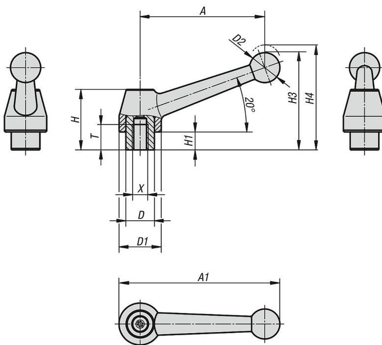
**Зажимные рычаги из нержавеющей стали, электролитически полированные, с внутренней резьбой, резьбовая вставка из нержавеющей стали - inch**
