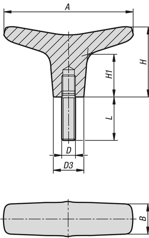
**T-образные рукоятки из нержавеющей стали с наружной резьбой для исполнения Hygienic USIT®, уплотнительная и плоская шайба Freudenberg Process Seals**
